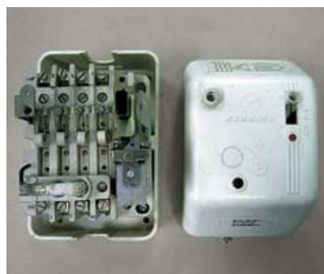
Abb. 2: Innen- & Außenansicht FI-Schalter Type BD (ca. 1964)
